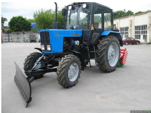
Рис. 4.1. Снегоуборочная машина МТЗ-82 с отвалом для снега
